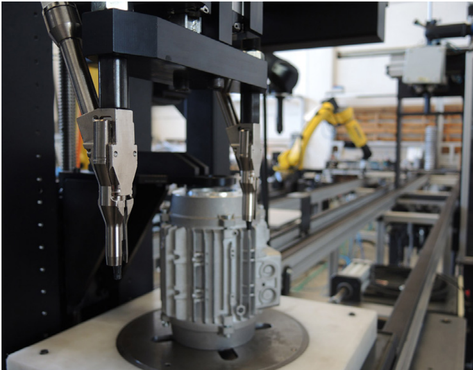
Sistema di avvitatura doppio montato su una linea di assemblaggio
